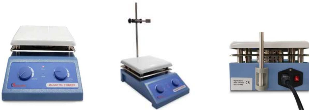
El agitador magnético de cerámica es ampliamente utilizado para calentar y agitar líquidos simultáneamente, proporciona una temperatura uniforme, la temperatura de calentamiento y la velocidad de agitación son ajustables; ideal para laboratorios escolares, investigación, industria alimenticia, farmacéutica, entre otras áreas.
